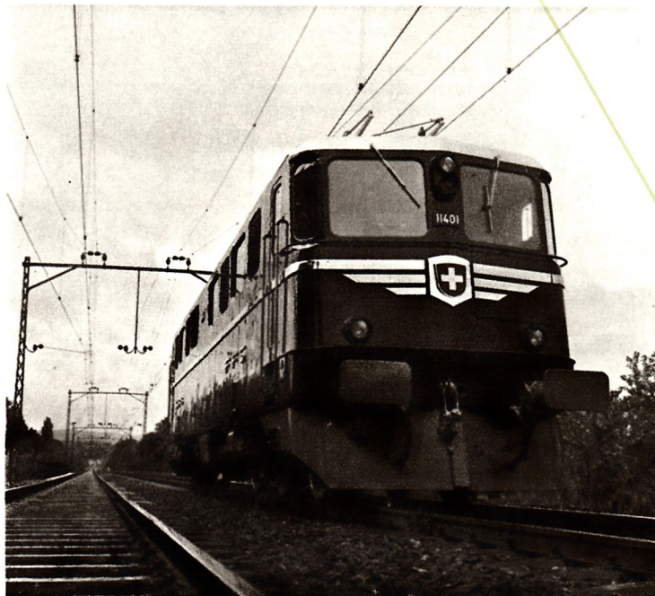
La locomotive des trains rapides CFF d'une puissance de 6000 CV
